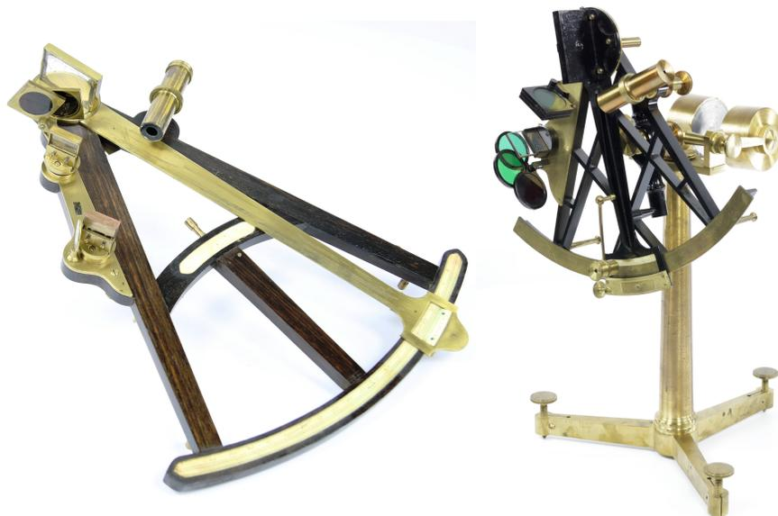
**Figura 4.2:** Octante de Spencer, Browning and Rust (izquierda) y sextante de Stancliffe (derecha) (fines del siglo XVIII).
