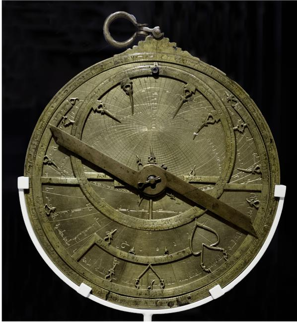
**Figura 1.5:** Astrolabio astronómico de Ibrahim ibn Sa'id al-Sahli. Construido en bronce y latón en un taller de Toledo en 1067.
